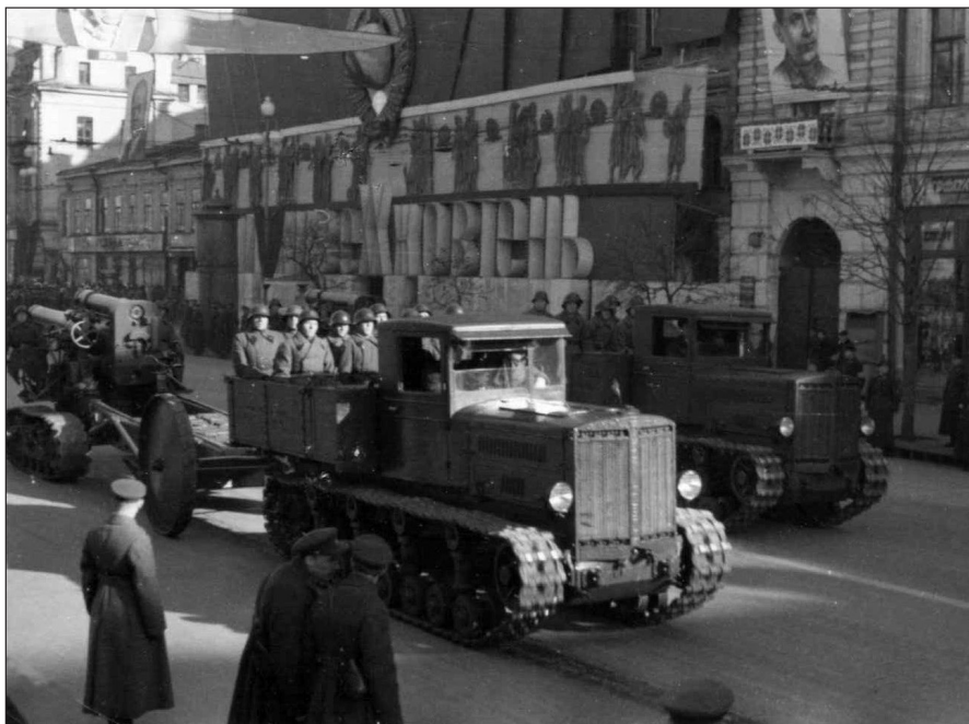
Fot. 3. Średni, gąsienicowy ciągnik artyleryjski typu „Komintern” holujący 203 mm haubicę wz. 1931 (B–4) jednej z formacji ciężkiej artylerii dyspozycyjnej RKKK podczas defilady 1-majowej w Charkowie – 1 V 1936 r. (zbiory własne autora)
